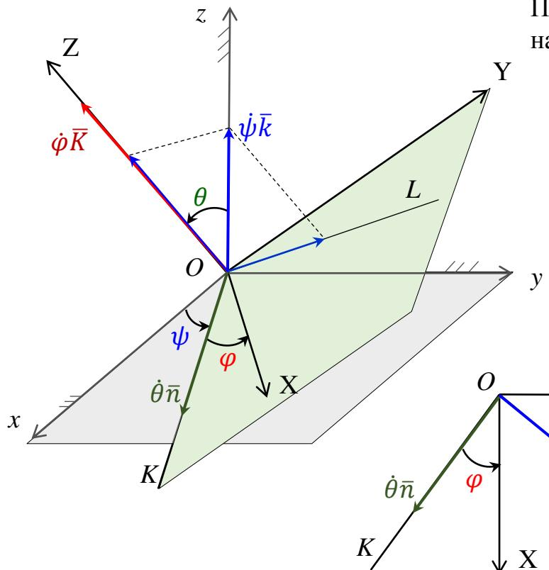
Получим проекции вектора  $\bar{\omega} = \dot{\phi} \bar{K} + \dot{\theta} \bar{n} + \psi \bar{k}$  на оси подвижной системы координат OXYZ.
