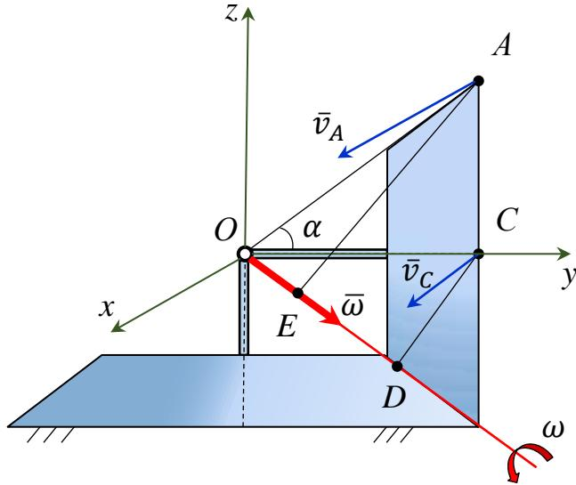
**Пример.** Найти угловую скорость конического катка (бегуна), и скорость его точки А, если скорость центра основания катка С, движущегося по окружности радиуса ОС = R постоянна и равна  $v$ . Каток катится без скольжения по неподвижной конической поверхности. Радиус основания катка АС =  $r$ .
