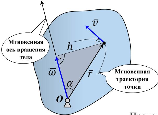
Линейные скорости точек тела при вращении вокруг неподвижной точки можно вычислить по формуле Эйлера, как и в случае вращения вокруг неподвижной оси, только радиус-вектор каждой точки удобно проводить из неподвижной точки:
