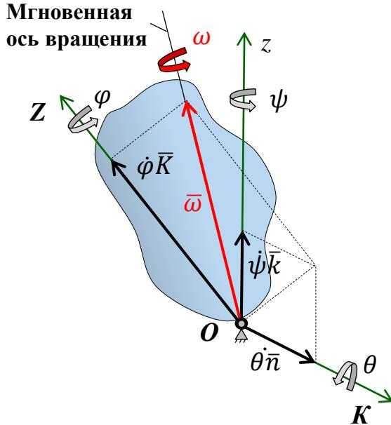
**Мгновенная ось вращения** – вектор, направленный вдоль мгновенной оси вращения твердого тела в сферическом движении так, что с конца его поворот тела виден против часовой стрелки, модуль которого равен:
