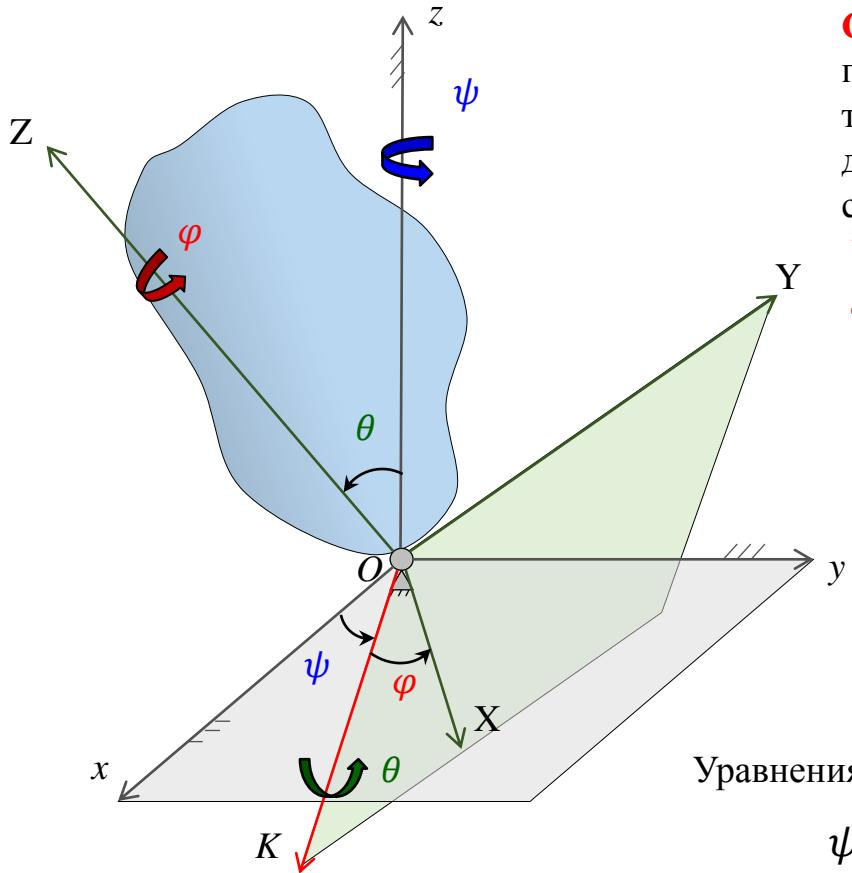
**Сферическим** называется такое движение твердого тела, при котором во все время движения одна и та же точка твердого тела остается неподвижной. Остальные точки движутся по сферическим поверхностям, центры которых совпадают с неподвижной точкой.
