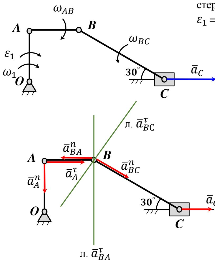
Для заданного положения механизма определить угловые ускорения стержней  $AB$  и  $BC$  и ускорение точки  $B$ . Если  $OA = AB = 1 \text{ м}$ ,  $\omega_1 = 1 \text{ рад/с}$ ,  $\varepsilon_1 = 4 \text{ рад/с}^2$ ,  $\omega_{AB} = \sqrt{3} \text{ рад/с}$ ,  $\omega_{BC} = 1 \text{ рад/с}$ ,  $a_C = 1 \text{ м/с}^2$ .
