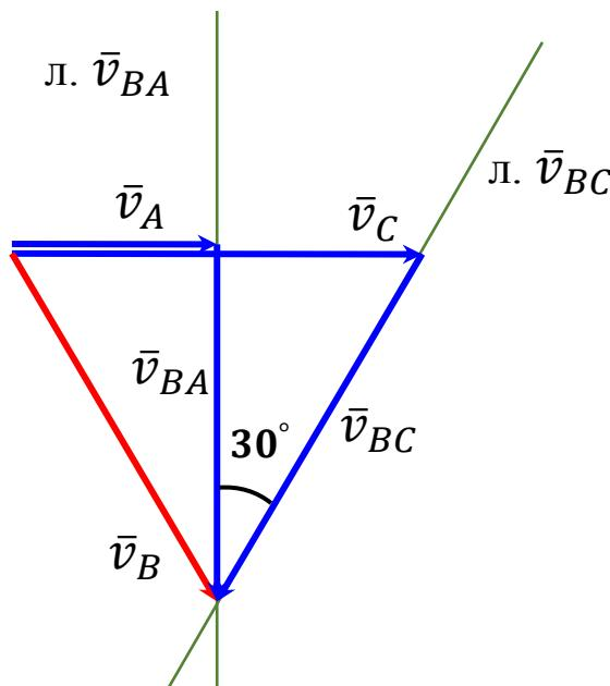
Направление угловых скоростей определяем по векторам скоростей  $\bar{v}_{BA}$  и  $\bar{v}_{BC}$ .
