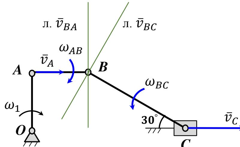
Для заданного положения механизма определить угловые скорости стержней  $AB$  и  $BC$  и скорость точки  $B$ , если  $OA = AB = 1 \text{ м}$ , угловая скорость кривошипа  $OA$  равна  $\omega_1 = 1 \text{ рад/с}$ , скорость ползуна  $C$  равна  $v_C = 2 \text{ м/с}$ .
