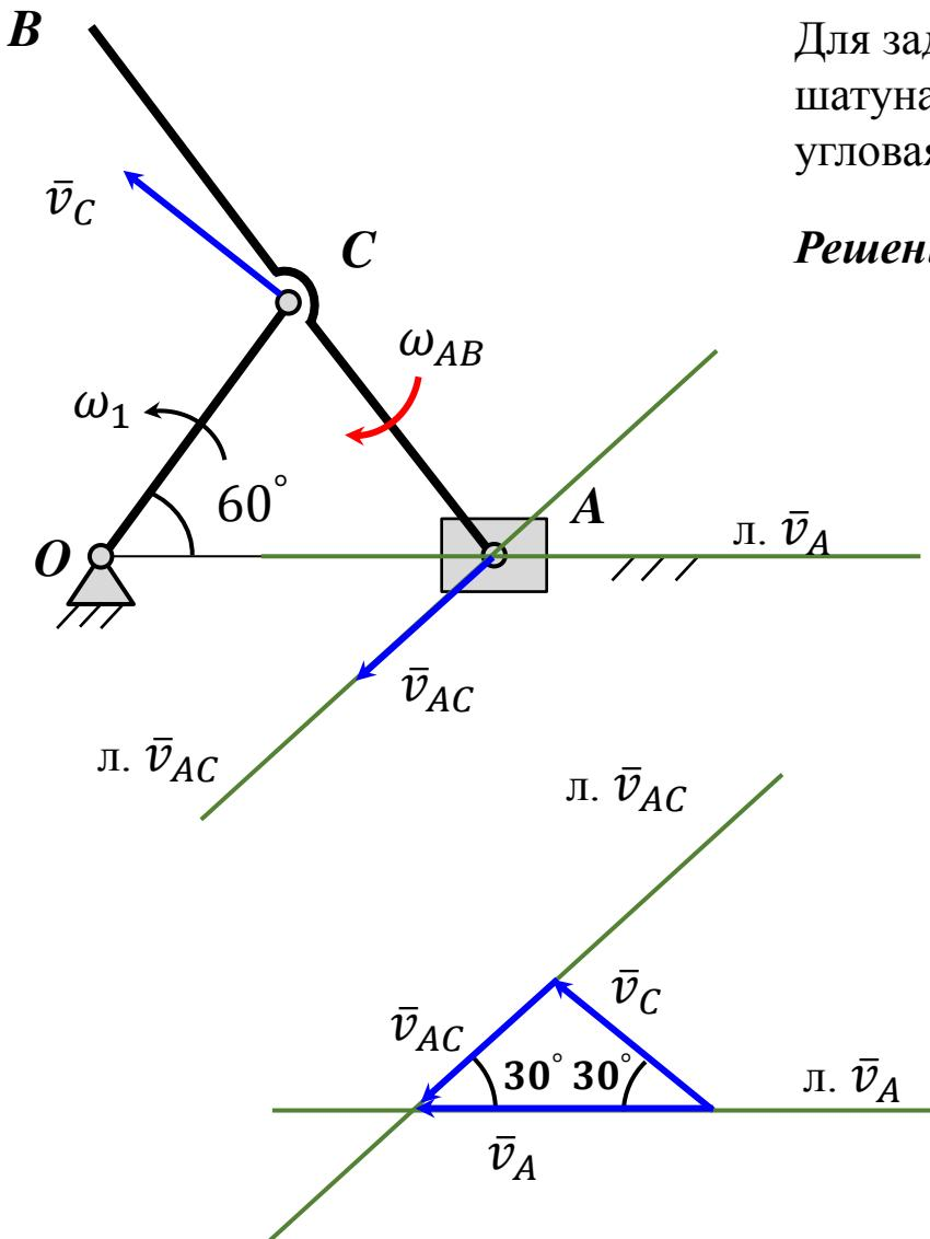
Для заданного положения механизма определить угловую скорость шатуна  $AB$  и скорость точки  $B$ , если  $OC = BC = AC = 0,25$  м и угловая скорость кривошипа  $OC$  равна  $\omega_1 = 4$  рад/с .
