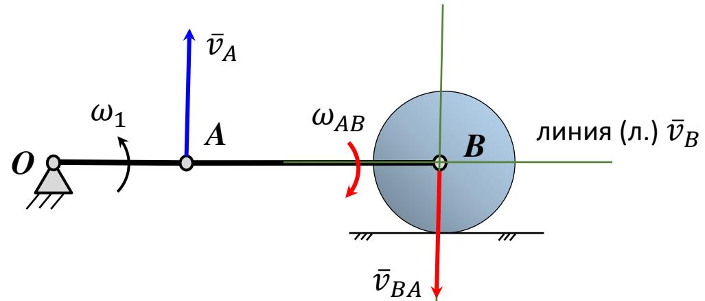
Для заданного положения механизма определить угловую скорость шатуна  $AB$  и скорость точки  $B$ , если  $AB = 2OA = 1$  м и угловая скорость кривошипа  $OA$  равна  $\omega_1 = 1$  рад/с.
