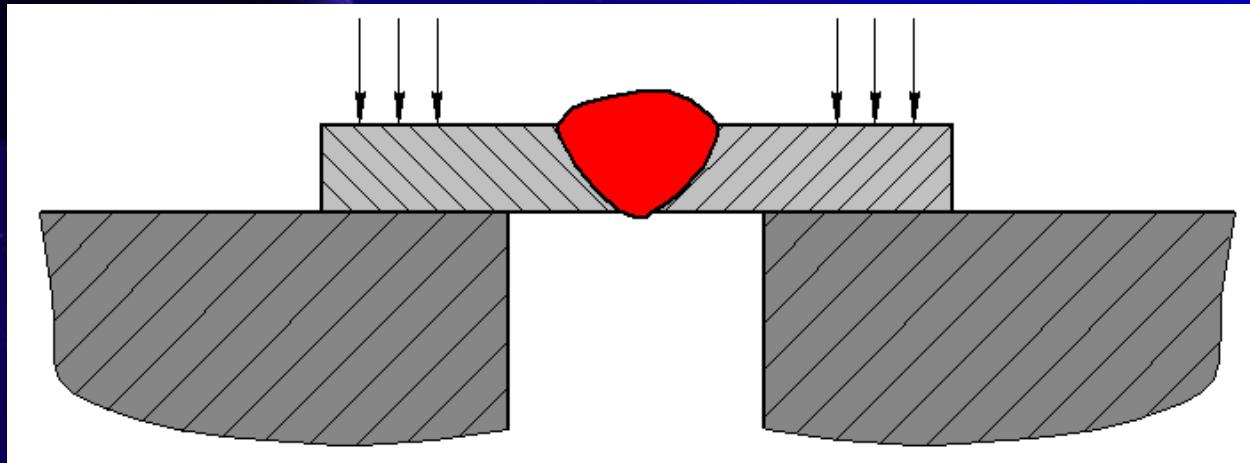
Устраняет только сварочные деформации
