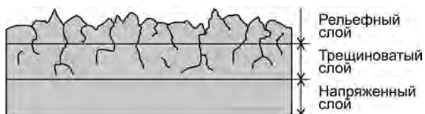
Рис. 2.20. Структура нарушенного слоя на поверхности кремниевой пластины
