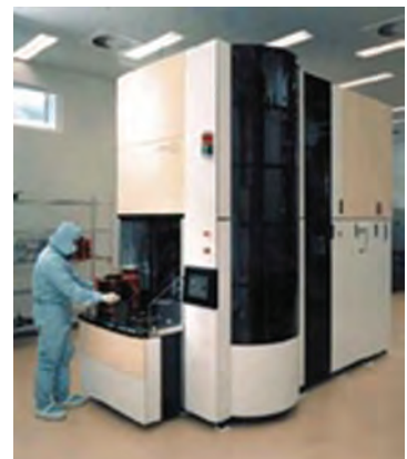
Рис. 2.49. Установка оксидирования кремния с вертикальным реактором:
