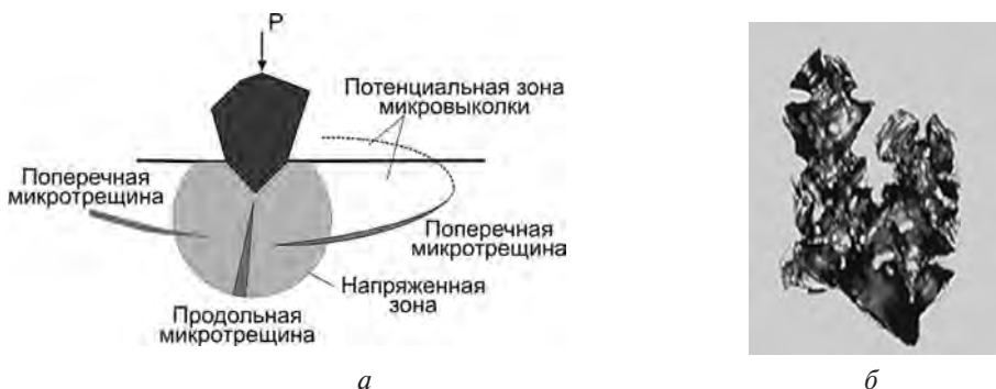
Рис. 2.21. Зона обработки свободным абразивом: а — формирование микротрещин и зоны микровыколки; б — микроосколок кремния
