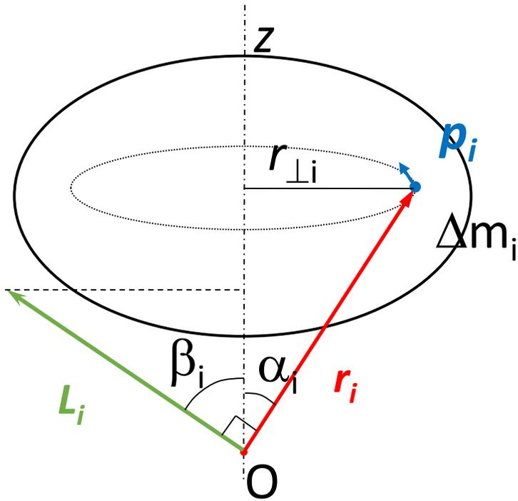
Момент импульса малой частицы массой  $\Delta m_i$ , находящейся на расстоянии  $\vec{r}_i$  и имеющей импульс  $\vec{p}_i$
