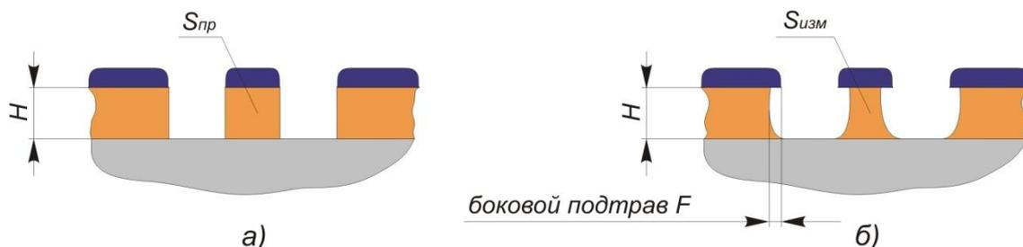
Рис.19. Площадь сечения проводников после травления: а) планируемая; б) измеренная
