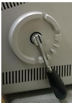
Рис. 9. Выставление зазора между валами ламинатора. Выбран паз № 2
